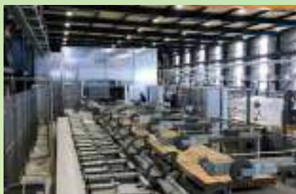
●高出力高周波プレスによる積層接着
