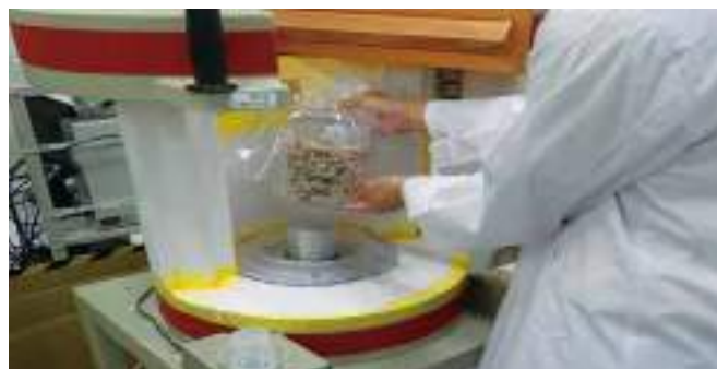
写真2 ゲルマニウム半導体検出器を用いた放射性セシウム濃度測定検査の様子
