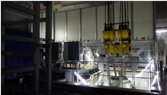
(写真1-1) サイトバンカ建屋2階から輸送容器 (カスク)の吊り下げ状況①
