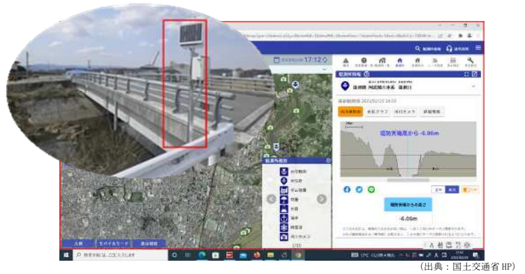
危機管理型水位計の設置
