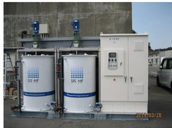
水産物の高鮮度保持技術の導入(シャベット氷製造装置)
