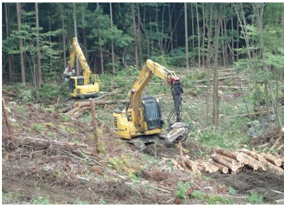
高性能林業機械による伐木造材
