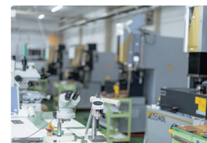
放電加工機 加工精度は±0.002mmを実現
