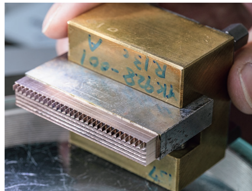
放電加工に使用する電極（画像は0.1幅の立ち上がり30本のもの）
