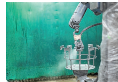
多関節ロボット塗装の様子
