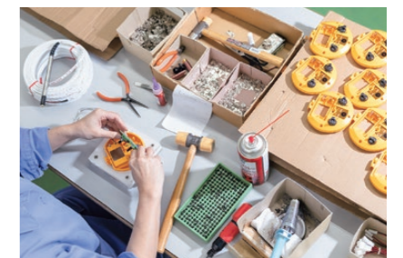
水位計巻尺 センサー部組立
