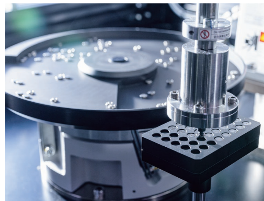
ロボットとパーツフィーダの融合フリーピッキング供給システム
