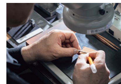
熟練者による手作業でのバリ処理
