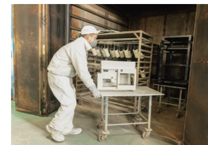
固定乾燥炉内の様子
