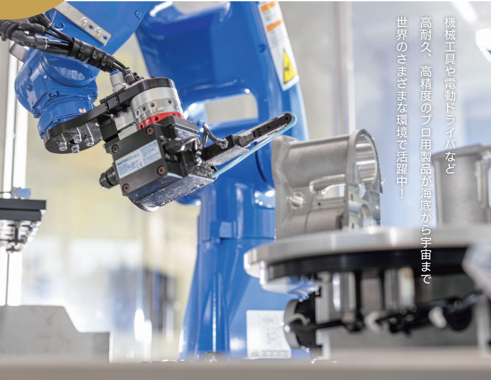
自社製品を応用した、自動バリ取り装置
