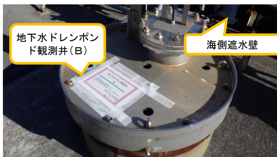
(写真 6－1) 地下水ドレnpン観測井（B）（上部に 水位計あり）
