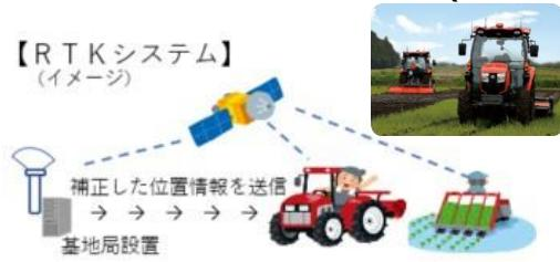
自動操舵システムを用いる作業の大幅な精度向上に向け、GPS位置情報の補正情報をスマート農機に提供するRTK基地局を県内一円に設置しました。また、このシステムを活用したスマート農機を普及推進し、県内の土地利用型農業の生産力向上を図ります。
