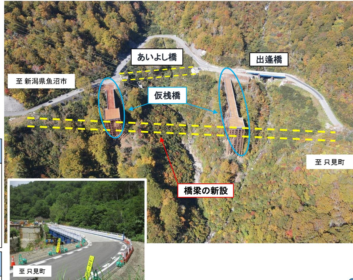
令和7年4月に出逢橋の流失が確認され、仮道工事を実施し8月8日に再開通しましたが、11月4日より冬期通行止めとなっています。また、新橋を施工するための仮桟橋が完成しました。
