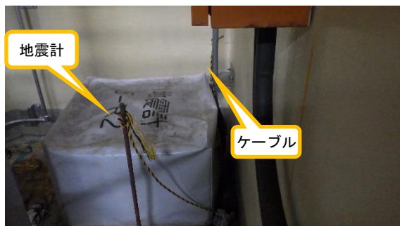
(写真 1) 地震計（基礎版上（地下 1 階））の 設置状況
