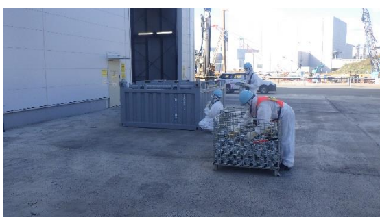
(写真1-1) コンテナの表面線量率を測定している様子
