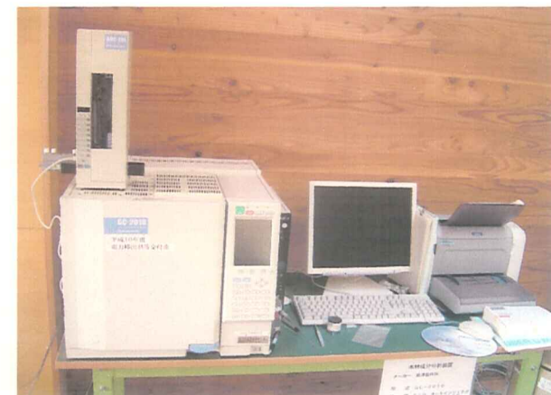
6 クロマトグラフ装置(木材成分分析装置)
