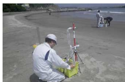
〈水浴場の空間線量測定の様子〉
