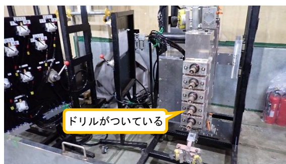
(写真 4－2) 孔を開けるための機械 ※ドリルの向きが横向きのものもある。
