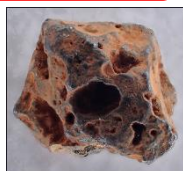
燃料碎片樣本(第2次)的放大照片
