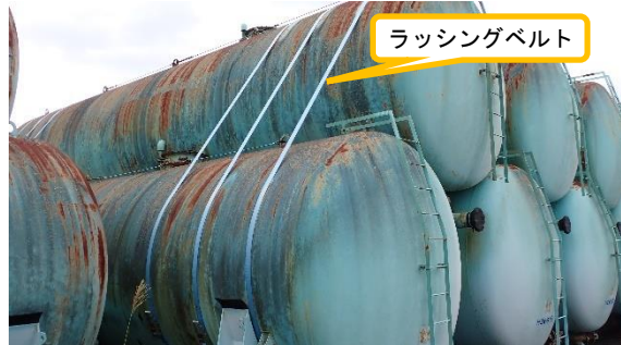
(写真 4 ②) ラッシングベルトによる 固定状況
