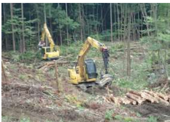
高性能林業機械による伐木造材
