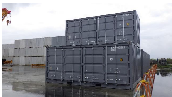
(写真 3 ②) タンク解体物を収納した コンテナの保管状況
