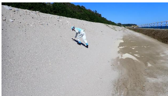
(写真 3) 浚渫土砂の盛土部分にお ける線量測定状況
