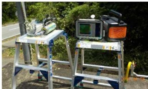
写真1 1 測定状況（左：NaI サーベイメータ
