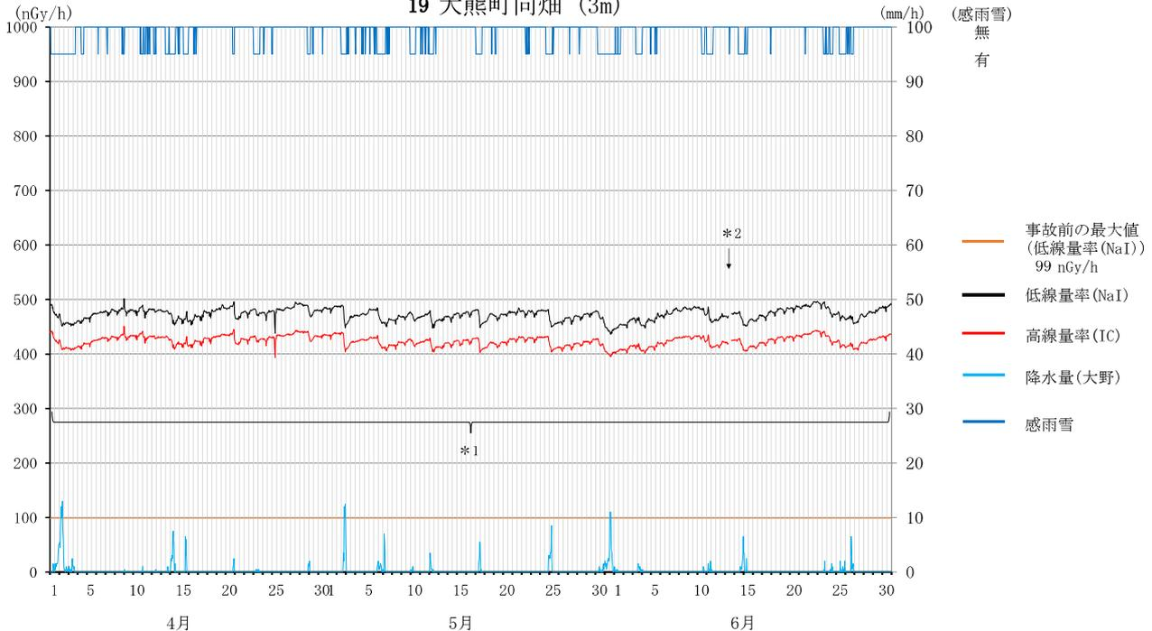
\*1 局舎付近に帰還困難区域入退域ゲートがあり、朝夕の渋滞時の車両の遮へいにより、線量率低下が発生
