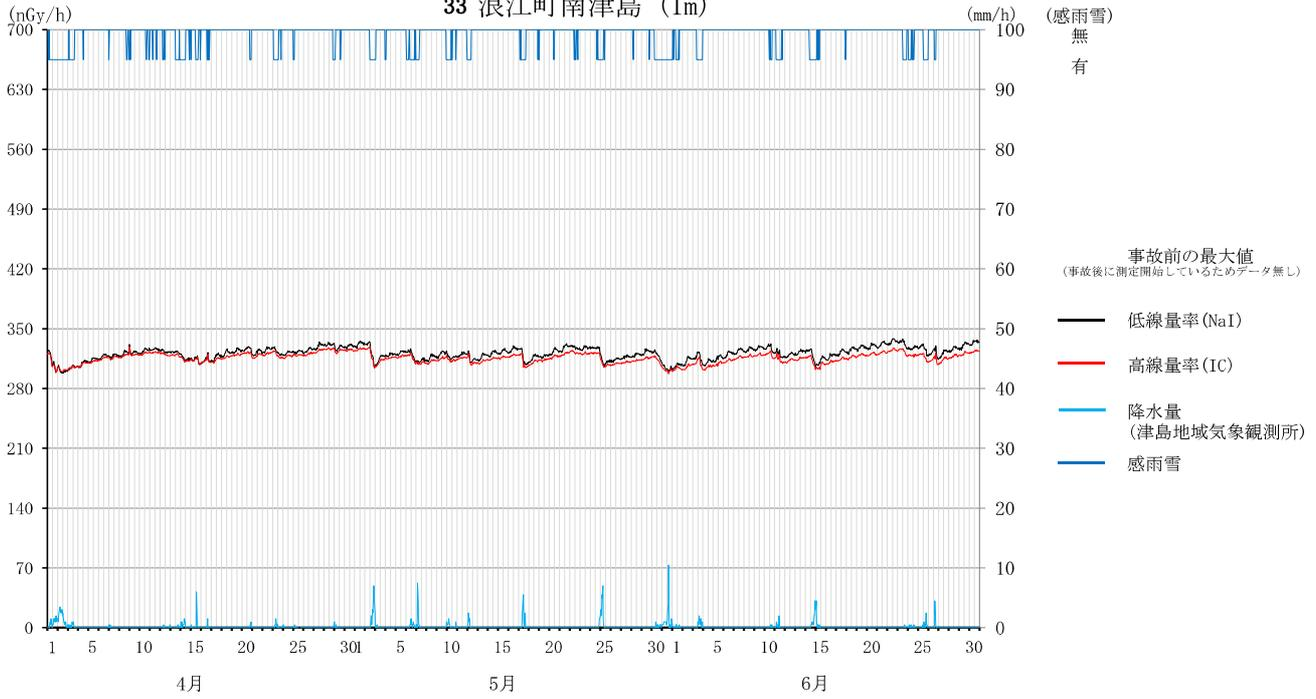
電離箱式検出器 (IC) は高エネルギーの宇宙線についても測定できることから、線量率が低レベルのときの測定値は NaI (TI) シンチレーション式検出器より 30nGy/h 程度高くなる。また電離箱式検出器は、検出器の形状が球形であり方向特性が良好である一方、NaI (TI) シンチレーション式検出器の形状は 21nφ × 21n の円柱状であるため、鉛直方向の方向特性を 1 とした場合、90 度方向では 1.1 程度となる。線量率が数百 nGy/h 以上の地点では、福島第一原子力発電所の事故により沈着した Cs-134 及び Cs-137 による地表面方向 (90 度から 180 度) からの放射線が大部分を占めるため、検出器の方向特性の違いによる影響がより顕著に現れ、電離箱式検出器と比較して NaI (TI) シンチレーション式検出器の測定値が高い傾向となる。
