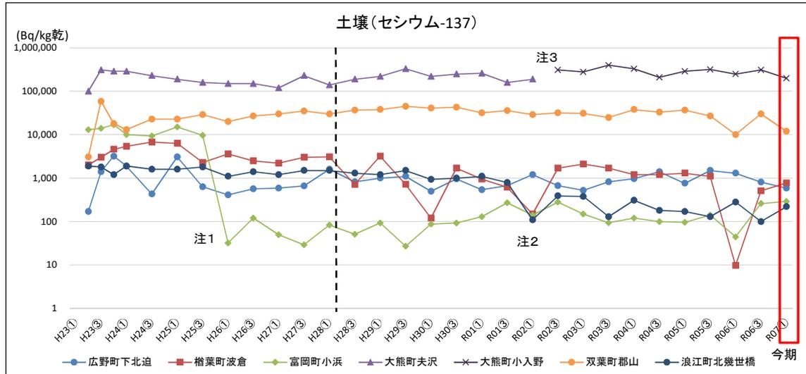
・事故後は緊急時の簡易法で分析しており検出下限値が高かったが、平成28年4月(点線)から分析方法を従来の方に戻し、検出下限値が低下。
