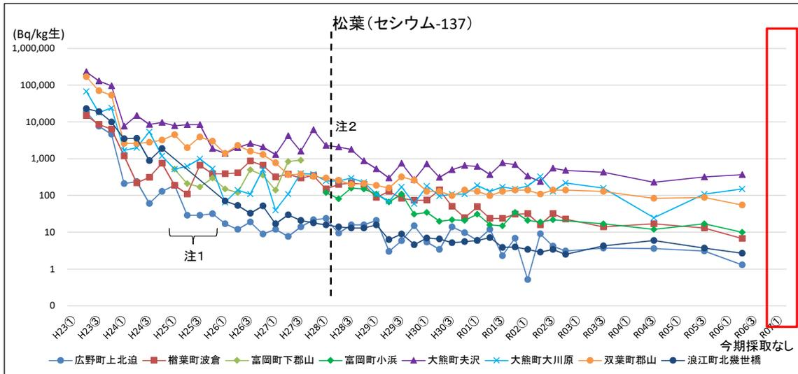
・事故後は緊急時の簡易法で分析しており検出下限値が高かったが、平成28年4月(点線)から分析方法を従来の方法に戻し、検出下限値が低下。
