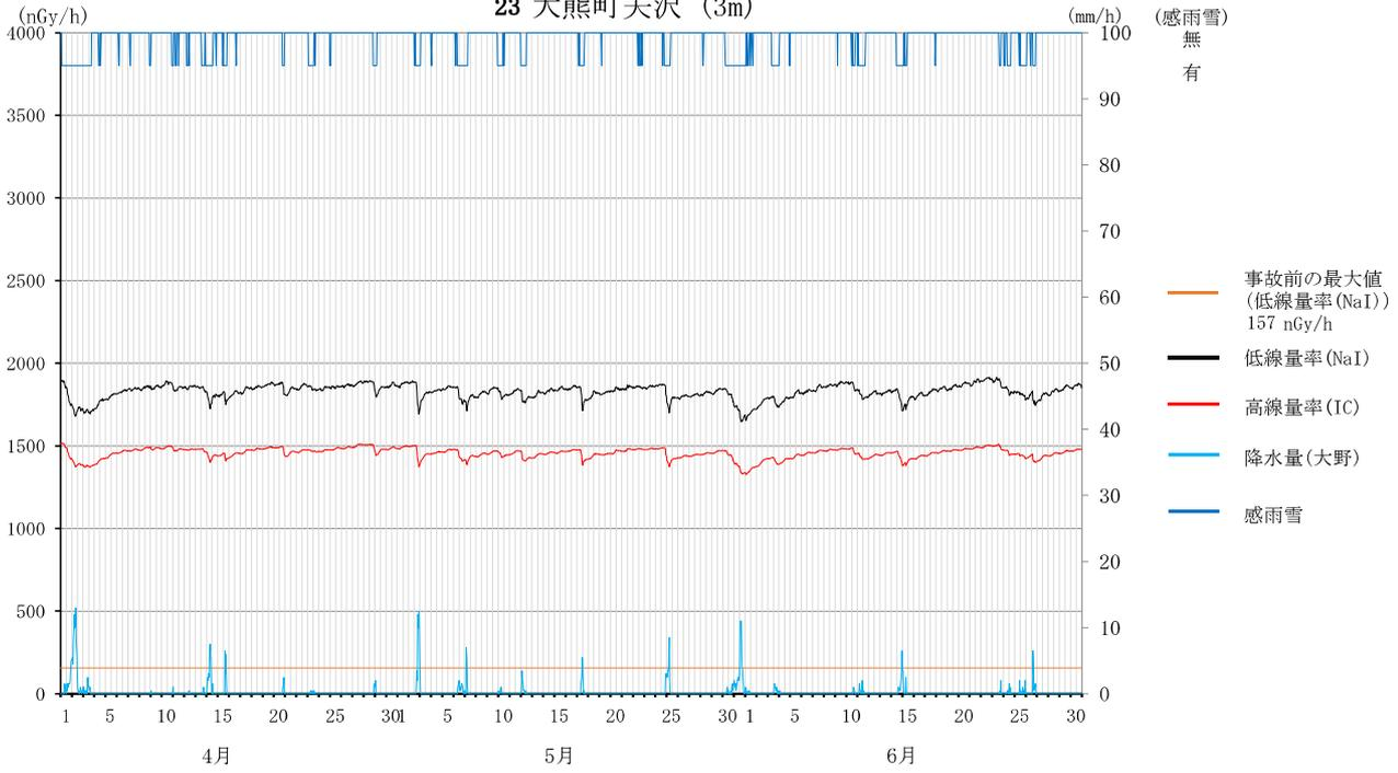
電離箱式検出器 (IC) は高エネルギーの宇宙線についても測定できることから、線量率が低レベルのときの測定値はNaI (TI) シンチレーション式検出器より 30nGy/h程度高くなる。また電離箱式検出器は、検出器の形状が球形であり方向特性が良好である一方、NaI (TI) シンチレーション式検出器の形状は2inφ×2inの円柱状であるため、鉛直方向の方向特性を1とした場合、90度方向では1.1程度となる。線量率が数百nGy/h以上の地点では、福島第一原子力発電所の事故により沈着したCs-134及びCs-137による地表面方向 (90度から180度) からの放射線が大部分を占めるため、検出器の方向特性の違いによる影響がより顕著に現れ、電離箱式検出器と比較してNaI (TI) シンチレーション式検出器の測定値が高い傾向となる。
