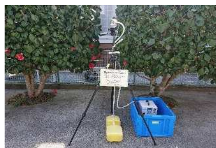
〈環境大気中のアスベスト濃度調査における試料採取の様子〉
