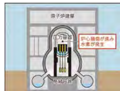
炉心の損傷が進み、水素が発生
