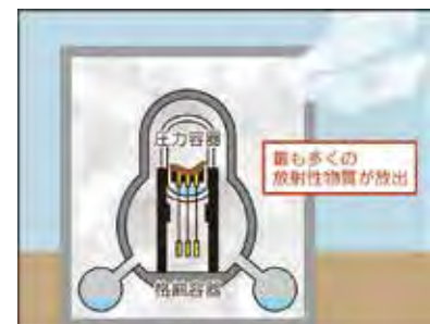
2号機の原子炉格納容器が破損し、放射性物質が放出
