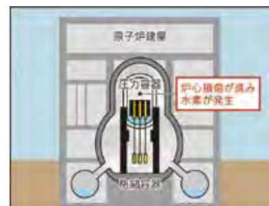
炉心の損傷が進み、水素が発生
