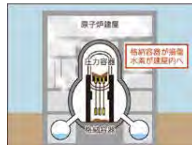
大量に発生した水素が原子炉建屋内に漏えい
