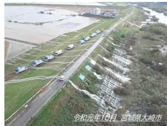
令和元年における排水ポンプ車の稼働状況（国土交通省HPより）
