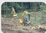
高性能林業機械による伐木造材
