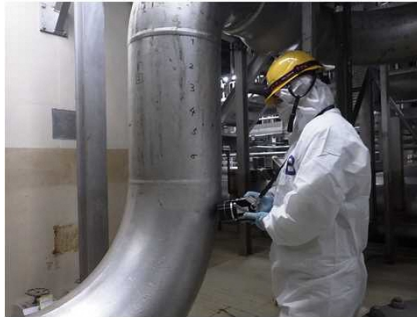
電離箱式サーベイメータによる線量当量率測定
