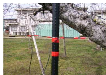
図2 温度センサーの設置方法
