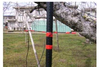
図2 温度センサーの設置方法
