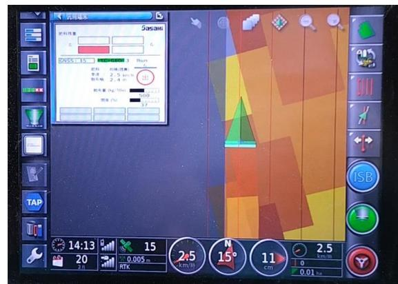
図 4-7 可変散布作業時のコンソール表示画面
