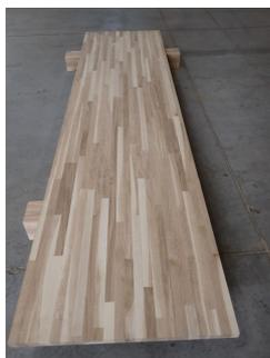
図-1 試作したコナラフリー板
