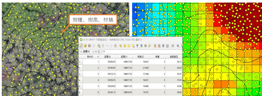
森林資源情報とオルソ画像（左）、空間線量マップ（右）の重ね合わせと、各種集計（中央）
