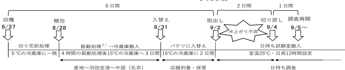
1) 振動処理方法: 郡山ハイテクプラザに梱包した箱を持ち込み小型輸送振動試験装置(m130LS)を使用した。試験条件はASTM D 4169-2014航空輸送とした。
