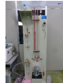
図4 変水位透水試験装置 (JIS規格準拠)
