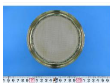
図3 フィルタ外観 （熱劣化付与試験後：一例）
