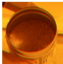
図2 セル内で分取したセシウム吸着材
