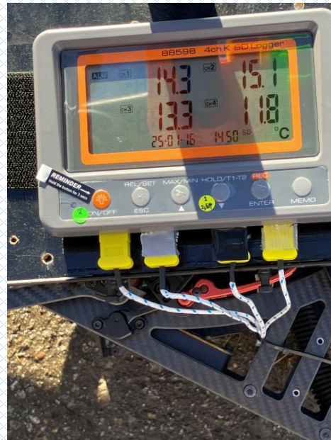
②気象観測機ALTAX バッテリー表面温度調査
