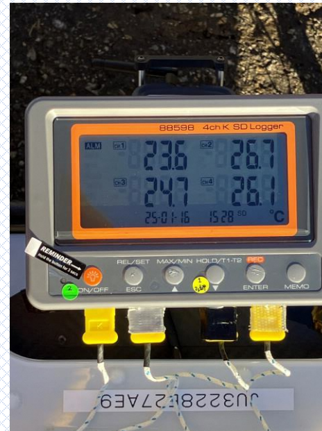
②物流機6150MP バッテリー表面温度調査
