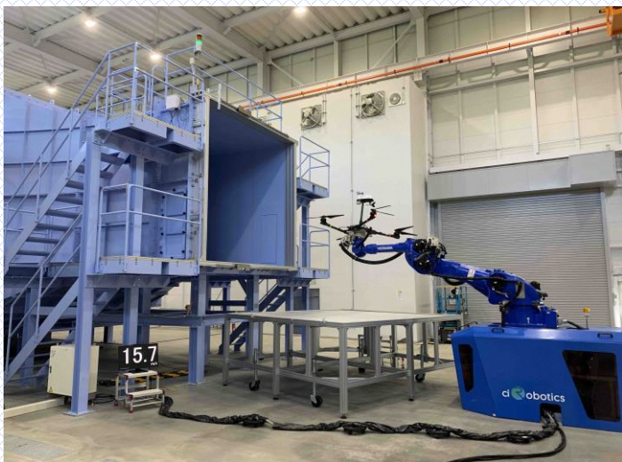
①RTF風洞試験棟でのウェザーステーション搭載 米国製ALTAXドローンによる風速試験
