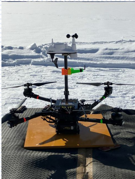
②気象観測機ALTAX バッテリー表面温度調査
