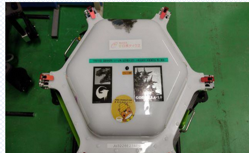
②物流機6150MP キャノピー内外構造
