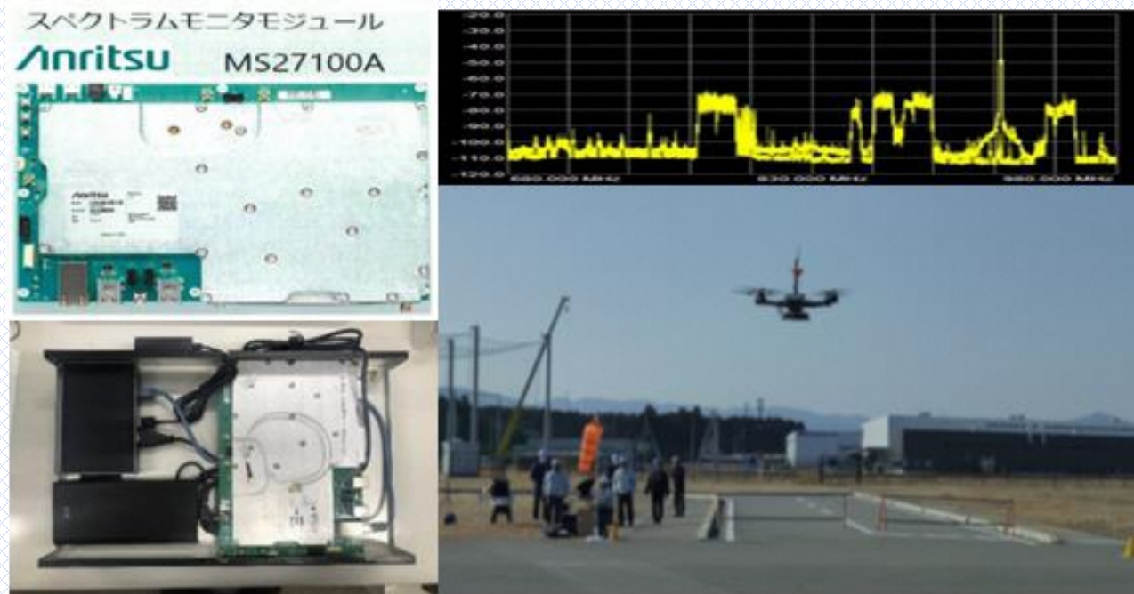
RTF滑走路でのアンリツ製スペクトルアナライザウェザーステーション搭載 ALTAXドローンによる電磁環境調査
