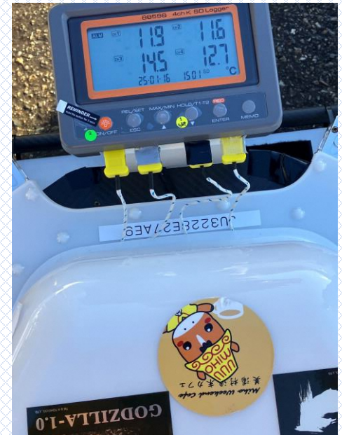
②物流機6150MP バッテリー表面温度調査
