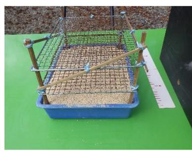
図-4 倒伏防止用金属網
