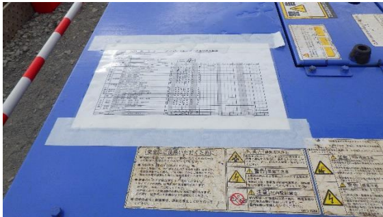
(写真 3 - 4) 溶接機に掲示されている日常点検結果
