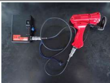
図1 電動ぶどう巻つる処理機 (ニッケンかみそり株式会社、試作機)
