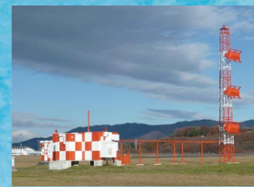
グライドスロープ(GS) 着陸のため進入中の航空機に対し適切な進入角を電波によって示す装置です。
