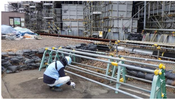
(写真5) 同集水エリア内での地表面の汚染検査の状況（ポイント3：瓦礫類一時保管エリアNのうちD排水路側に最も近い凹地の土砂堆積箇所）
