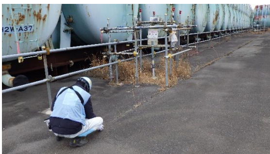
(写真 4) 同集水エリア内での地表面の汚染検 査の状況 (ポイント2: 横型ブルー タンク保管エリアCとタンク解体部 材一時保管施設の間隙部の土砂堆積 箇所)
