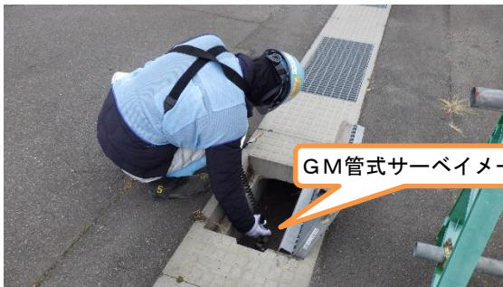
(写真 3) 同集水エリア内での地表面の汚染検 査の状況 (ポイント1: テント式 タンク解体部材一時保管施設の南側 雨水側溝)
