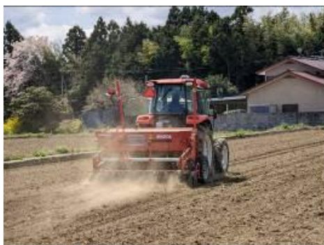
プラウ耕・グレーンドリル播種体系による 水稲乾田直播栽培の播種作業
