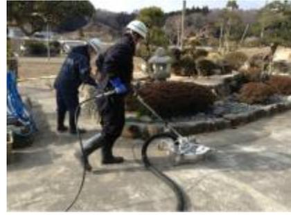
吸引型高圧洗浄機車載機器
