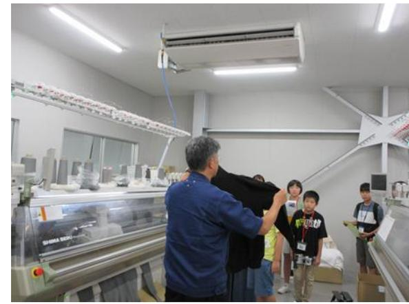
ほとんど機械化されている縫製工場を見学しました。機械による縫い目のない縫製が可能で、型紙からの縫製と違い布等にムダが生じないことが特徴的です。
