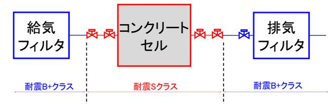
図. コンクリートセルの給排気弁（概念図）
