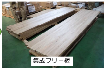
乾燥後のラミナを細割加工 縦継ぎ・幅はぎ・接着
