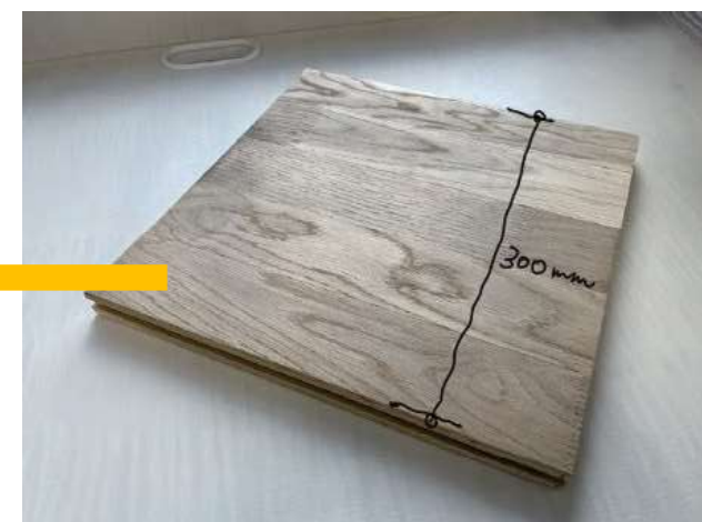
腰部板はトラック床板に使用する集成板
