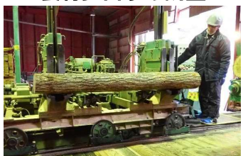
コナラ原木(末口径18~30cm) ラミナ(厚:36mm)へ製材
