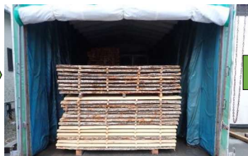
人工乾燥(テント式最高60°C) 天然乾燥
