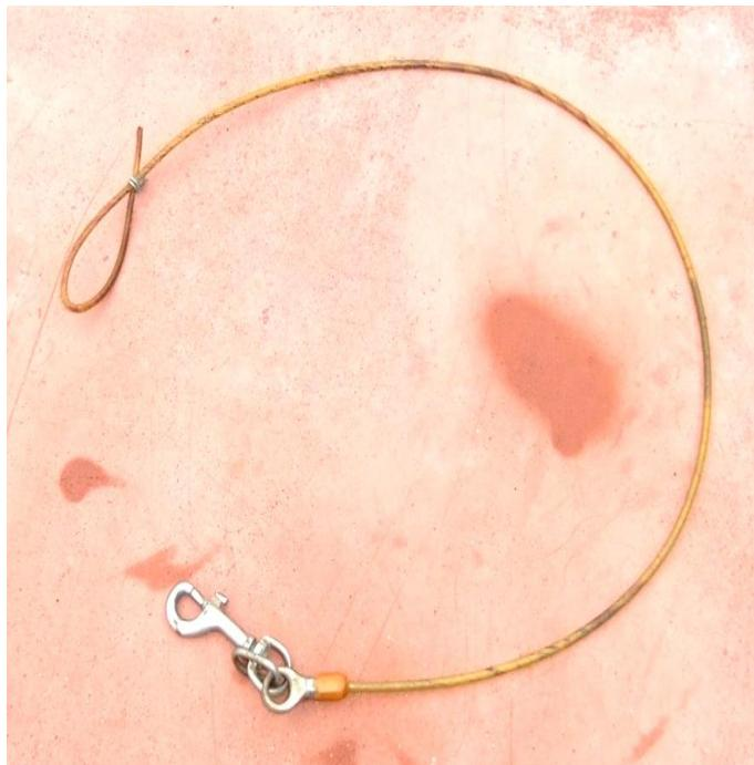
この製品の多くはワイヤーにビニールをコーティングしたもので、地面に擦れてワイヤーに傷がつくと、力が加わった時に容易に断裂します。そのため大型犬や引っ張る力が強い犬のけい留には向きません。また、使用する際は定期的に点検し、少しでも劣化があれば交換する必要があります。
