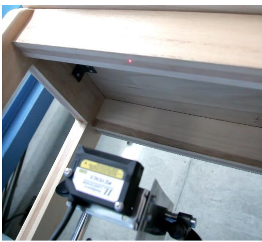
椅子の強度試験に活用（変位測定）
