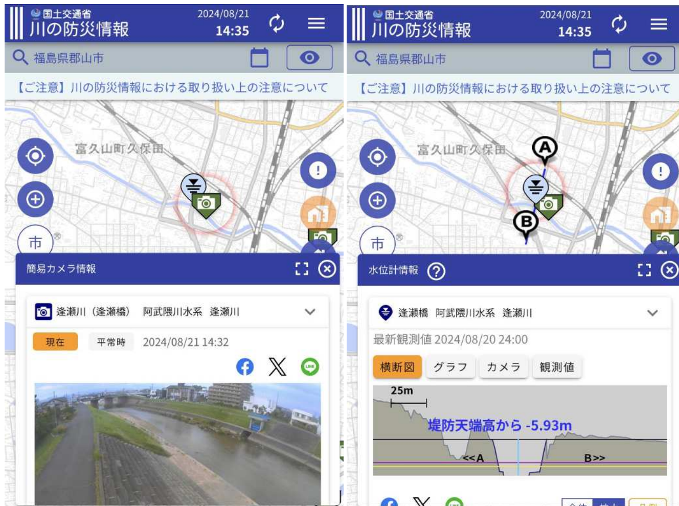
スマートフォンによる河川監視カメラ、河川水位の表示例 ＜逢瀬川（逢瀬橋）・郡山市＞
