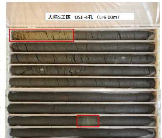
図2. ボーリング掘削で得られたコア(大熊⑤工区) ※地表近くは排気層、7m付近は排水層
