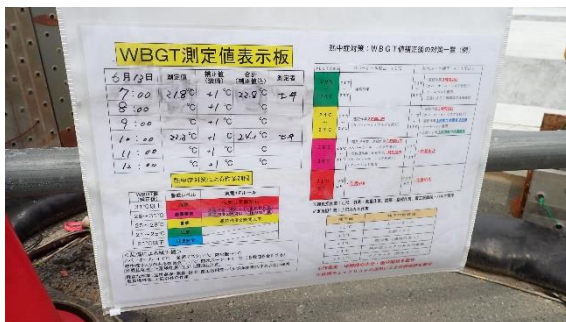
(写真3-2) 暑さ指数(WBGT)測定値の記録 掲示状況 (工事現場南側に設置)
