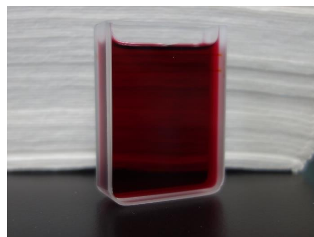
固体、粉体、液体など多様な試料の測定が可能 画像は液体測定用セル
